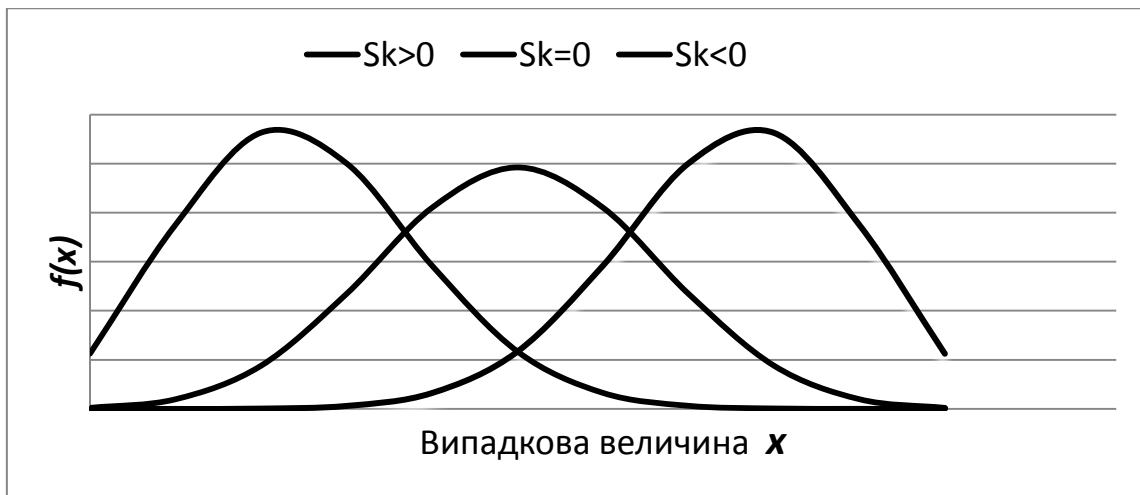
Рис. 3.5. Вплив коефіцієнта асиметрії на криву розсіювання
