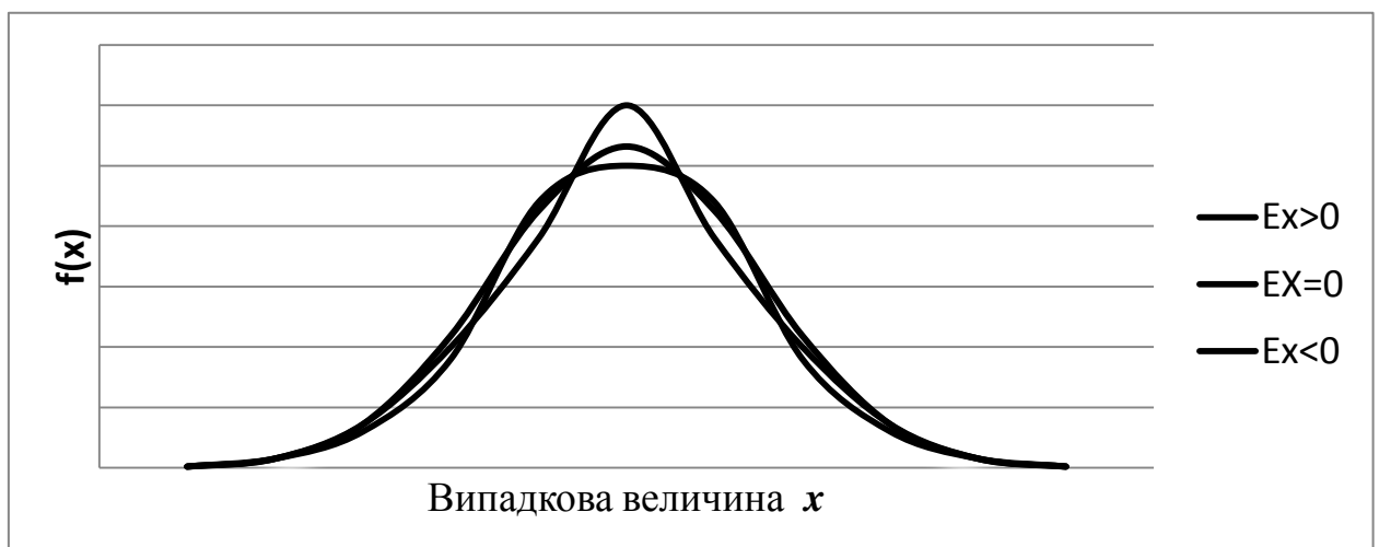
Рис. 3.6. Вплив коефіцієнта ексцесу на криву розсіювання
